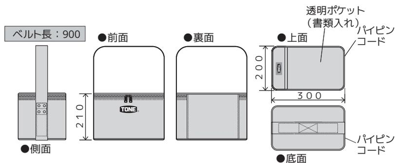
ボルト・ナットや工具類が収納・運搬できる便利なバッグ。軽量で丈夫な1680Dポリプロピレン生地を採用。内部に水が浸入しにくいように防水加工されボルト類を汚れや水濡れから守ります。開けやすいダブルジッパー。
