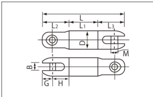
特殊鋼を使用し防水、注油式として重機械や衝撃の強いバケット、アースドリルなどに適しております。
